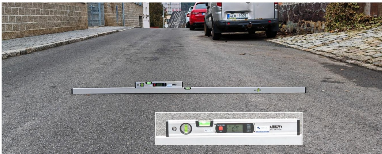
Obr. 4. Měření sklonu vozovky pomocí digitálního sklonoměru.
