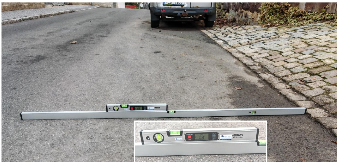
Obr. 5. Měření sklonu vozovky blíže nájezdu.
