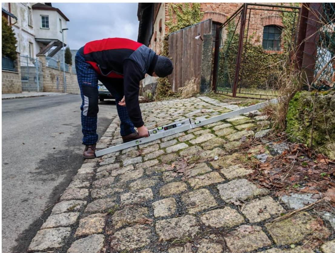
Obr. 5. Sklon nájezdu činí dle konkrétního příčného řezu mezi 24 a 27 %, lokálně bylo však naměřeno i více než 30 % (při měření na uvedené fotografii).
