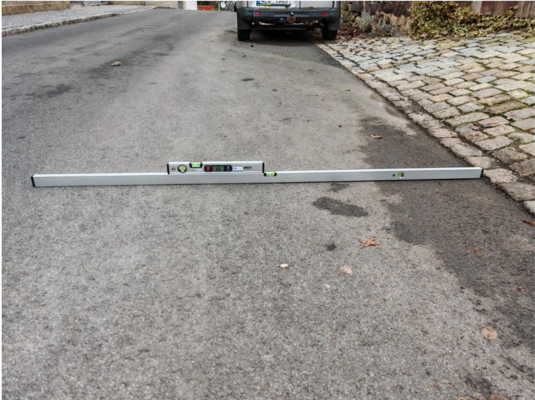
Obr. 3. Sklon vozovky v blízkosti nájezdu činí 0,5 %.
